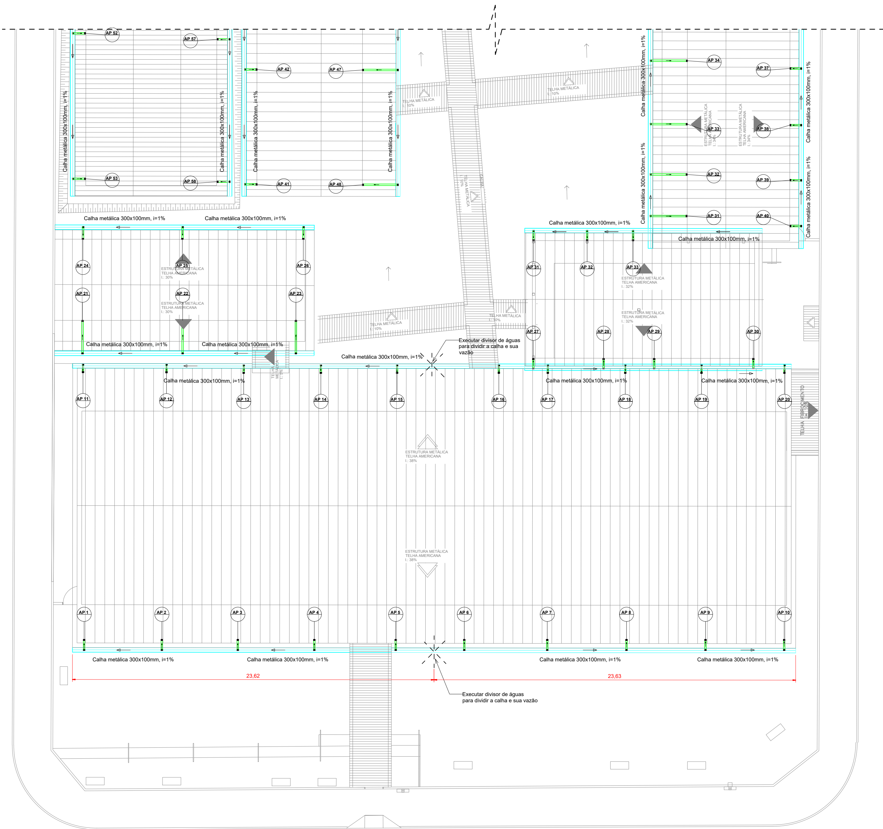
Planta de Cobertura - Drenagem da Cobertura - Parte 1 ESCALA: 1:100
